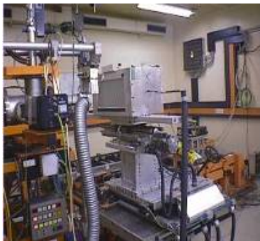
Simulation des LHC-Betriebs am Forschungszentrum Karlsruhe: Bestrahlung von 120 Sensoren, Hybriden und Modulen; Test im 8Tesla-Magnet.
