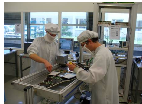
Bau von 102/288 Siliziumstreifen-Großmodulen der Endkappen im Reinraum, Karlsruhe
